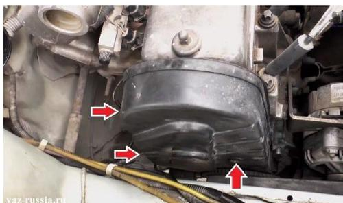
2) Теперь обесточьте автомобиль, скинув клемму минус с аккумуляторной батареи. Затем снимите ремень генератора. Выставьте поршень четвертого и первого цилиндра в ВМТ (верхняя мертвая точка). Проще говоря, оба поршня полностью ровно и без углов поставить вверх.
