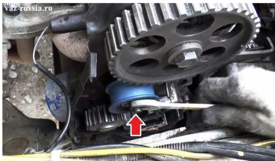
4) Следом снимите переднее правое колесо. Теперь берите вороток с накидной головкой либо любой другой ключ, способный отвернуть болт крепления шкива привода генератора (шкив указан красной стрелкой).
